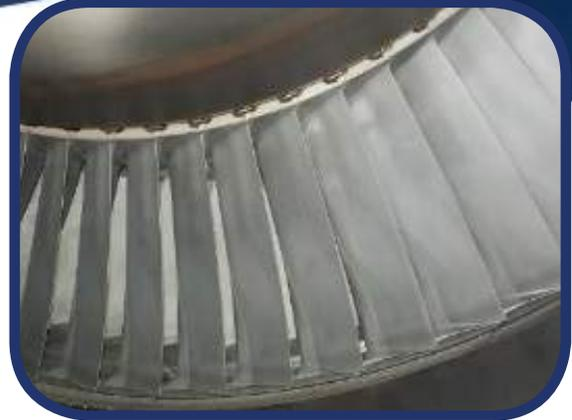
*Inspección de boroscopia de Etapas 1, 2 y 3 de turbina de potencia.*
