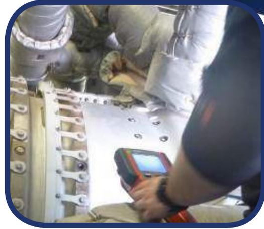
*Inspección boroscópica de turbina.*
